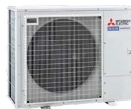
PUY-M125VDA Dimensions (W X D X H) : 1100 X 460 X 870 mm
